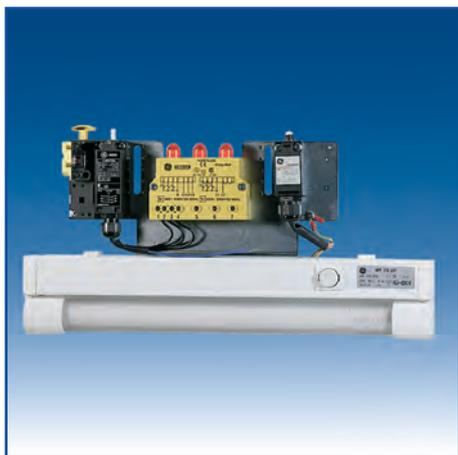
Apparecchio lampeggiante trifase con finecorsa di comando e lampada 18W completa di staffa di fissaggio. Tensione 380-500 V.
